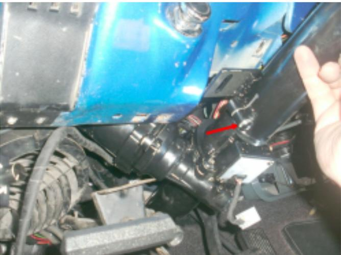
14. Lösen sie die inbus- schraube. (nicht entfernen!) Siehe foto zum vergleich.
