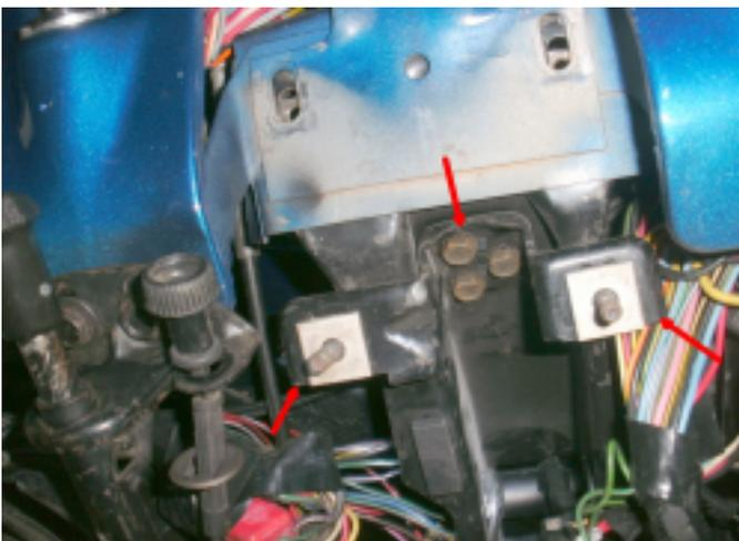
12. Entfernen sie die lenksäulen halterung. 3 bolzen.
