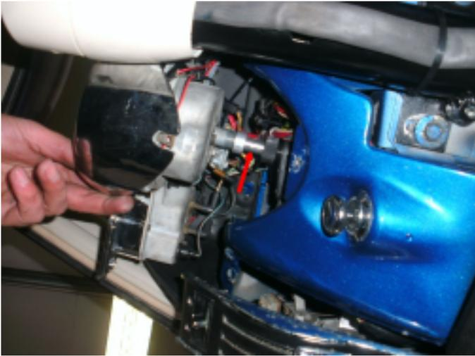
24. OPTIONAL: Es ist möglich einen tachogeber zu installieren (geschwindigkeitsabhängig). Diese montieren sie zwischen tachometer und tachowelle. Dieser wird dann in den ez- kabelbaum integriert. (stecker)
