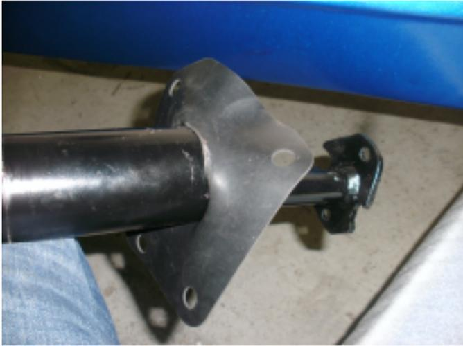
13. Montieren sie die original-gummimanschette auf die ez power steering lenksäule. Ebenso die befestigungsschelle.
