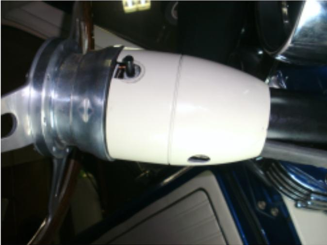
21. Achten sie auf den abstand zwischen lenkradnabe und blinkergehäuse. Hier sollte etwas "luft" sein.
