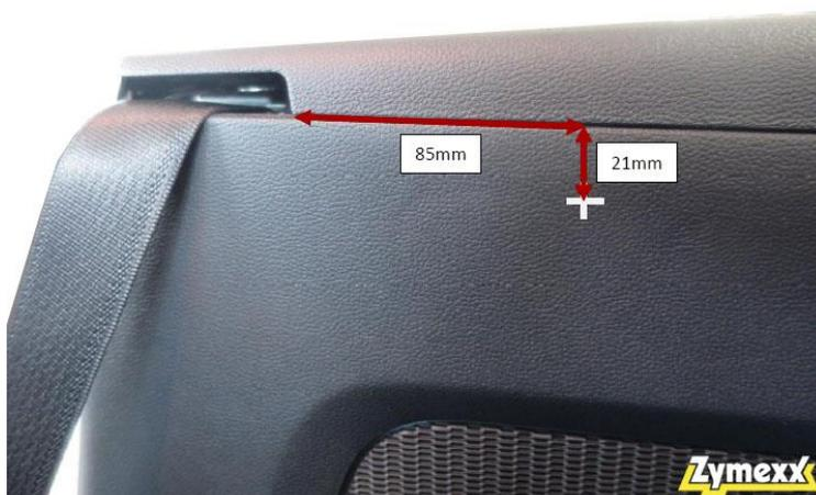
**Schritt 2:** Den Deckel der Seitenverkleidung mit Hilfe eines Kunststoffkeils o. ähnlichem vorsichtig entfernen & die Bohrung 12mm rechts & links setzen
