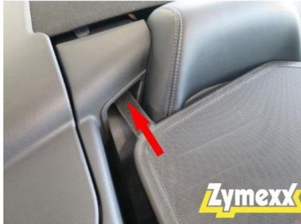
**Schritt 5:** Verriegelungsbolzen gegen die Federvorspannung zurückziehen und beidseitig in die angebrachten Schraubhülsen einrasten, fertig.
