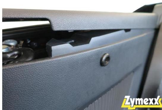
**Schritt 4:** Windschott mit Lasche an hinterer Gurtdurchführung einschieben.
