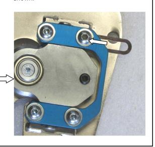
10.) Die Gleitrolle **(4)** muss so eingestellt werden, dass der LSD-Schwenkarm beim Öffnen und schließen und beim Hoch bzw. Runterschwenken unter leichter Vorspannung geführt wird. Evtl. ist die Gleitrolle mit einer Unterlage(n) **(H)** zu unterlegen.
