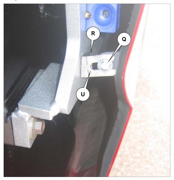
22.) Nun den bearbeiteten Kotflügel am Fahrzeug montieren.
