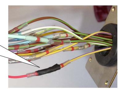
Am Schluss dann den kompletten Kabelbaum mit Hilfe des Gewebebandes wieder ummanteln. Achtung: Kabel beim ummanteln gerade halten.
