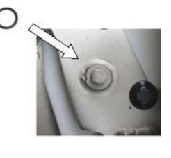
Die Dämpferkennzeichnung muss sichtbar sein / The signification on the gas spring must be visible
