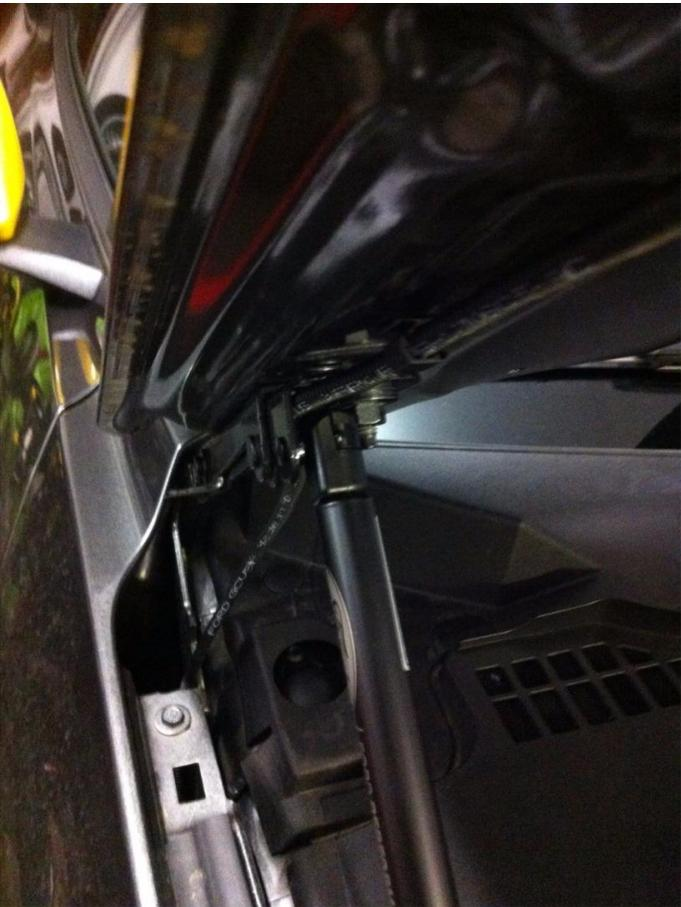
Auf der Beifahrerseite auf die Verlegung des Schlauches achten (siehe Bild).
