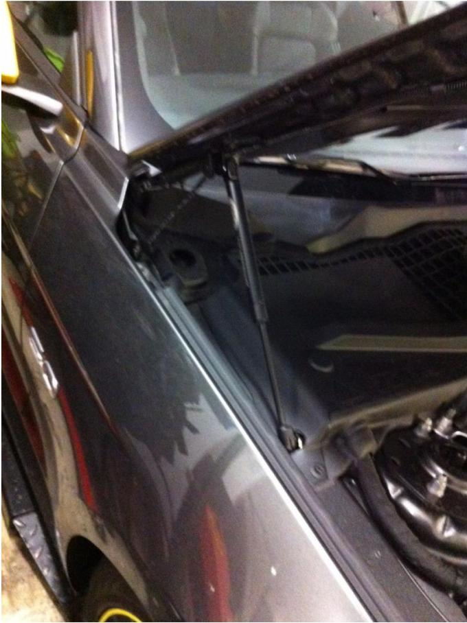
Zuletzt den blöden Haken mit einer 10er Nuss losschrauben und demontieren.
