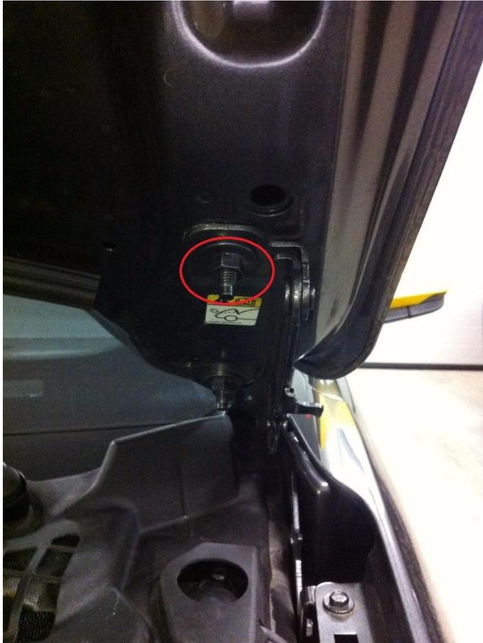
Jetzt den Halter aus dem Set aufstecken und die Mutter wieder aufschrauben. (Vorsicht den richtigen Halter verwenden, links und rechts sind verschieden):
