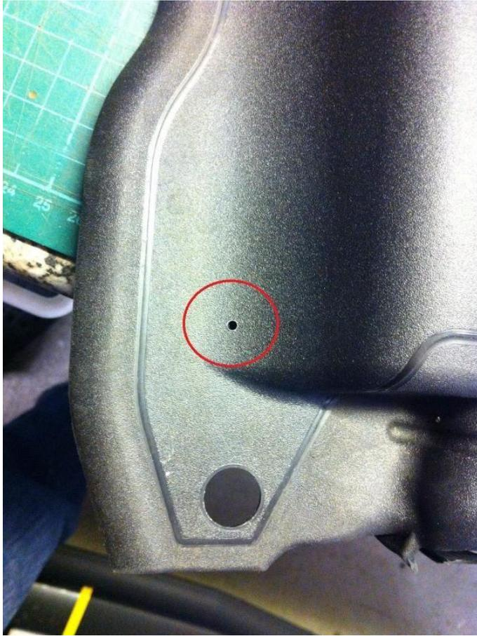
Anschließend das Loch mit dem Stufenbohrer auf 30 mm erweitern:
